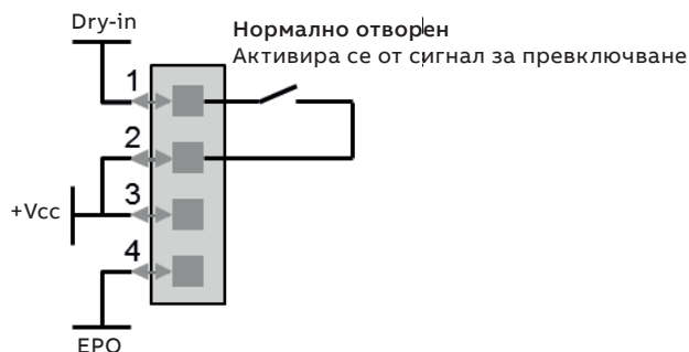
Фигура 25: Схема на входовете на сухия контакт
